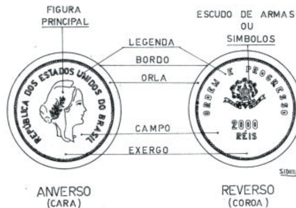
Partes constituintes de uma moeda
